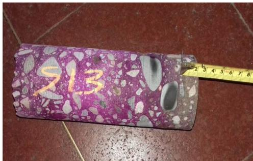
Figura 3. Determinación del frente de carbonatación mediante fenolftaleína
