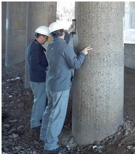
Figura 11. Detección de armaduras en columna
