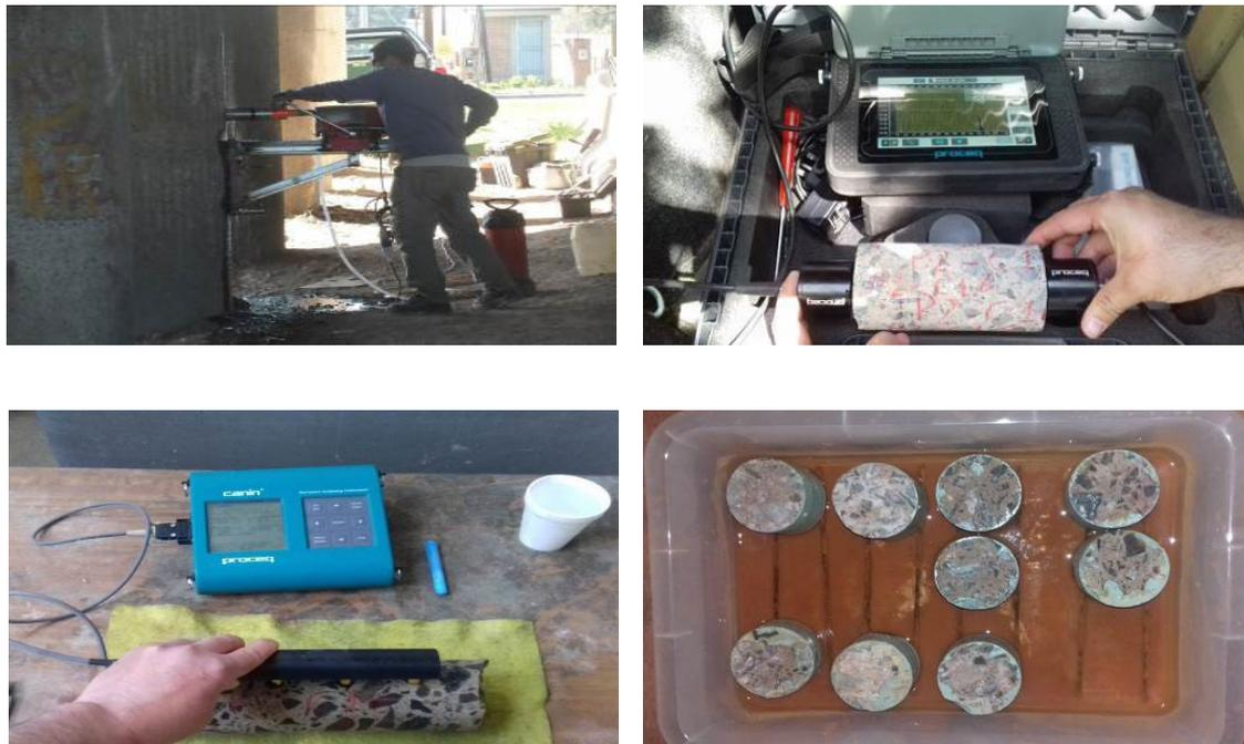
Figura 17. Ensayos en testigos de concreto extraídos
