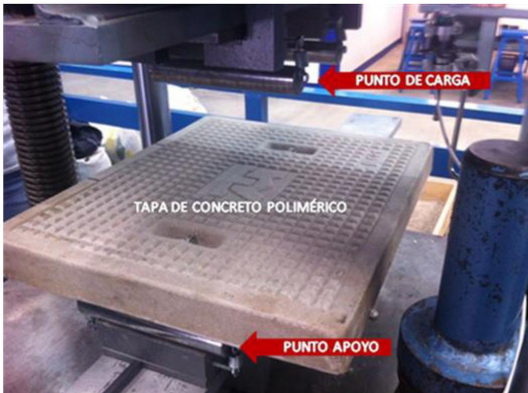
Figura 4. Tapa colocada sobre dispositivo en flexión
