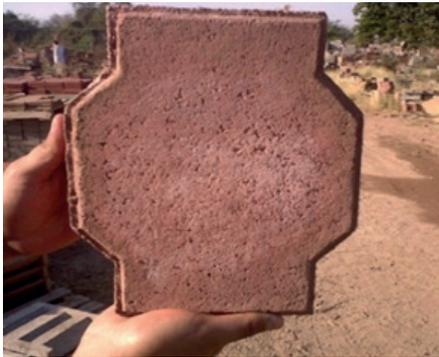
Figura 5. Adoquín Tipo Cruz de Tabasco
