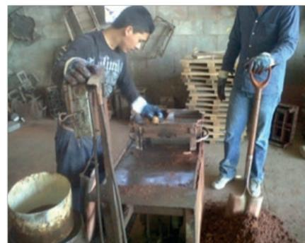
Figura 4. Fabricación de las piezas de adoquín
