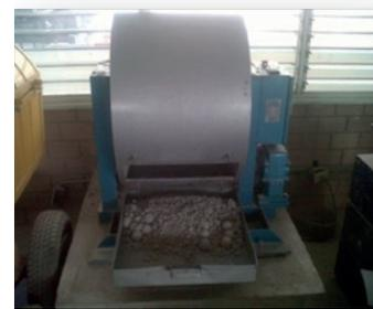
Figura 2. Preparación del material, etapa de trituración mecánica
