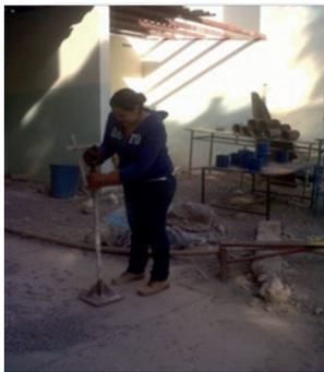
Figura 1. Preparación del material, etapa de trituración manual
