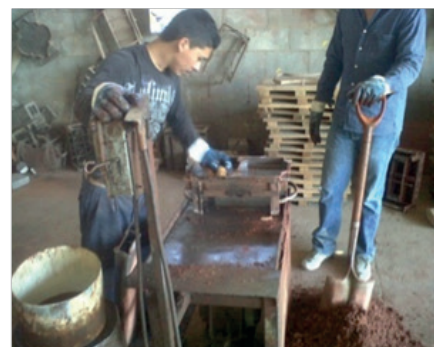
Figura 4. Fabricación de las piezas de adoquín
