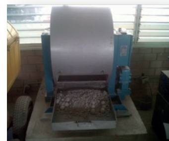
Figura 2. Preparación del material, etapa de trituración mecánica
