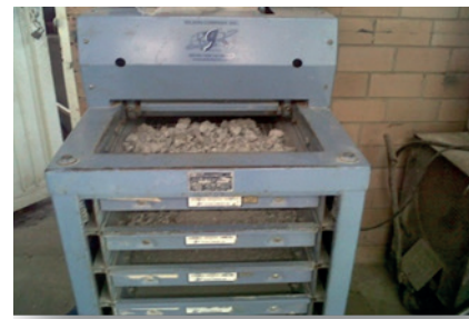
Figura 3. Cribado por mallas, se deja el material clasificado como arena (material con diámetro menor a 4.75 mm o que pasa la malla no. 4)
